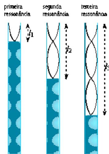
Da figura observa-se que as ressonâncias ocorrem em condições específicas, quando o comprimento da região vazia do tubo é um múltiplo de  $\frac{\lambda}{4}$ .
