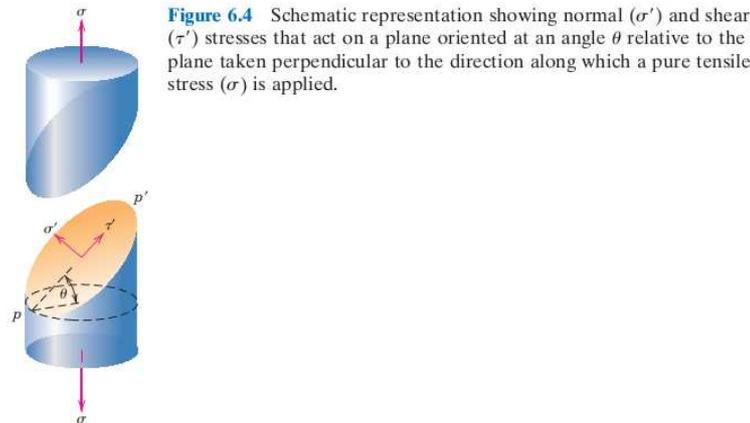
Figura 1: Tensão em uma área transversal  $A$ , projetada sobre uma área  $A'$
