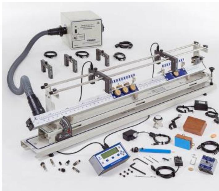
Figura 1 - Trilho de ar semelhante ao utilizado nos experimentos
